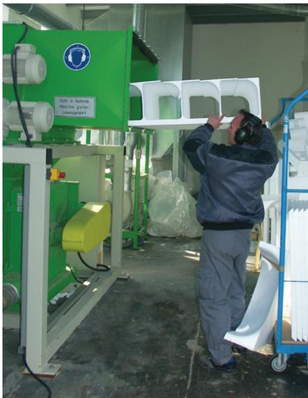
Werkseigene Recyclinganlage zum Zerkleinern von Styroporteilen
